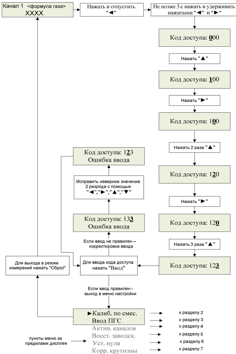
Примечание: из любого состояния можно вернуться в режим измерений, последовательно нажимая "Сброс".
