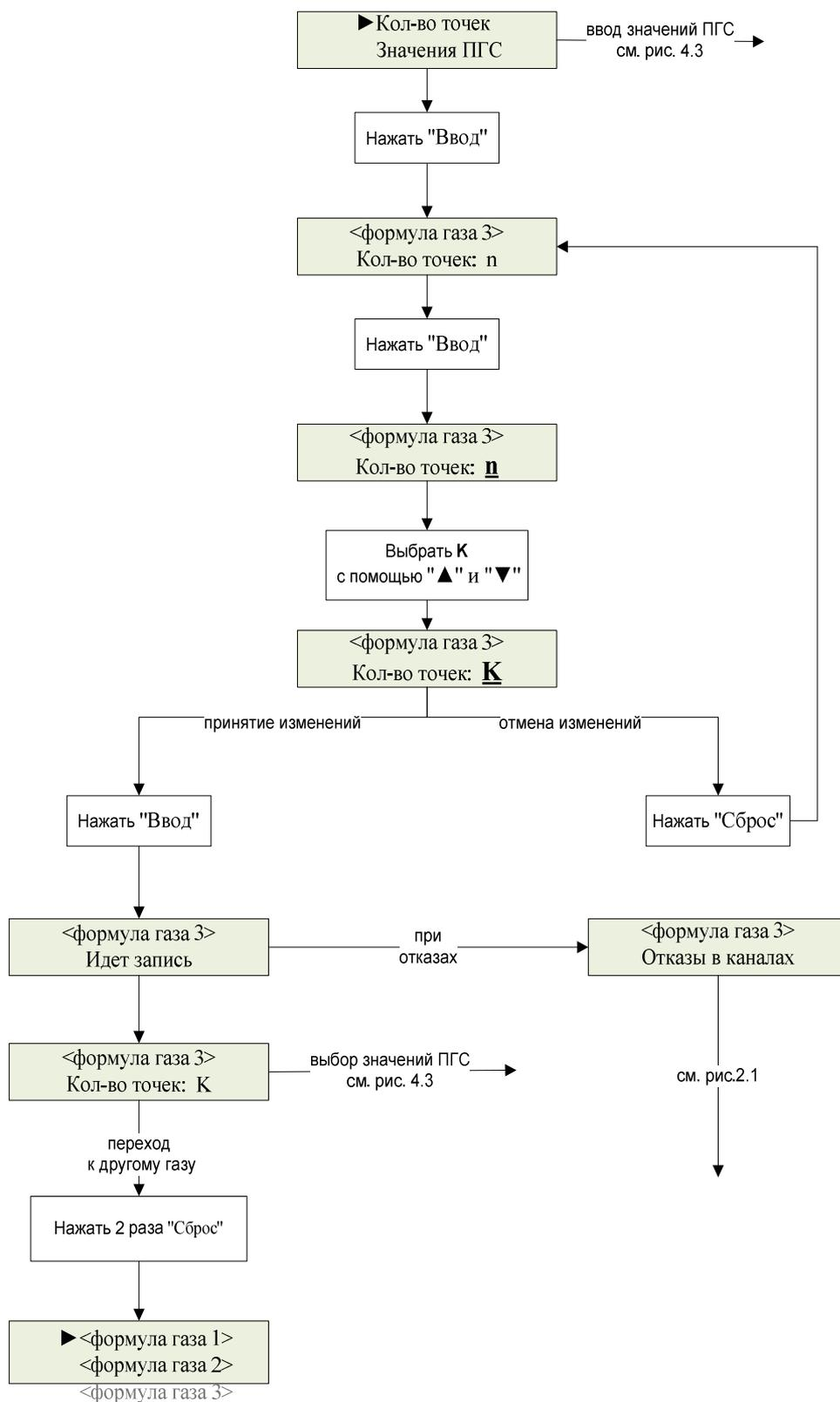
Примечание: из любого состояния можно вернуться в режим измерений, последовательно нажимая "Сброс".
