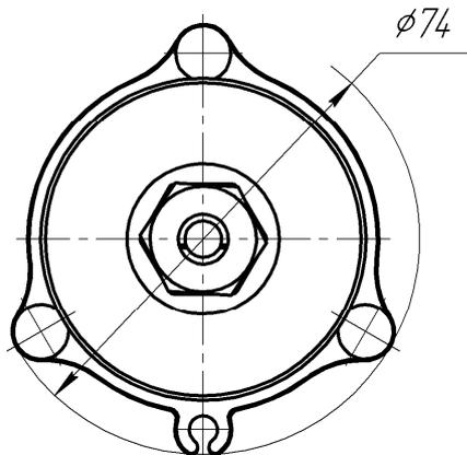
Рис.Е.8. Блок датчиков с разъемом 15EDGRC-3.81-04.
