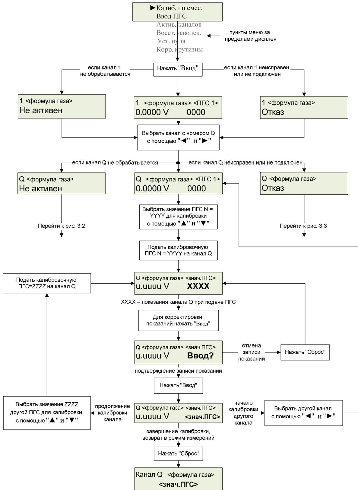
Примечание: из любого состояния можно вернуться в режим измерений, последовательно нажимая "Сброс".
