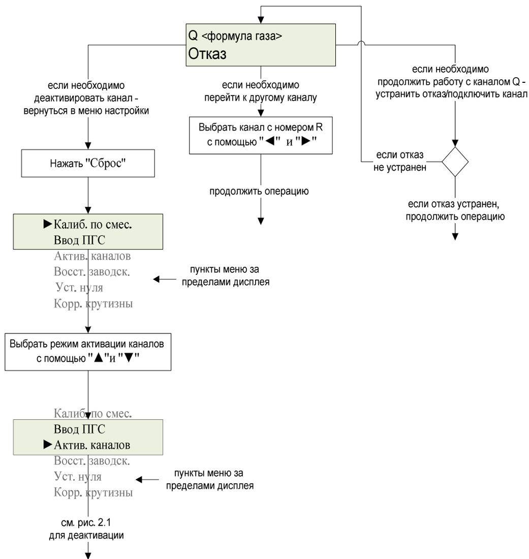
Примечание: из любого состояния можно вернуться в режим измерений, последовательно нажимая "Сброс"
