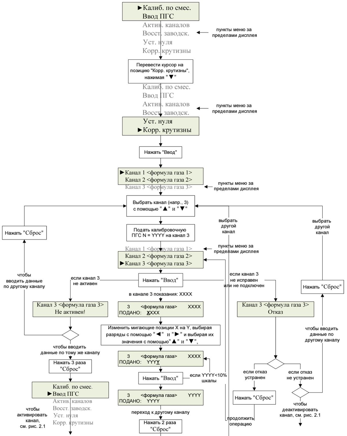
Примечание: из любого состояния можно вернуться в режим измерений, последовательно нажимая "Сброс".
