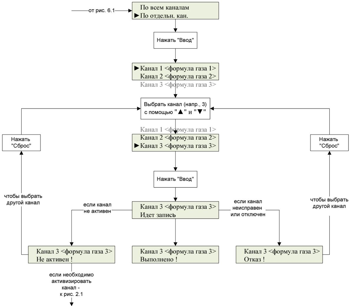
Примечание: из любого состояния можно вернуться в режим измерений, последовательно нажимая "Сброс".
