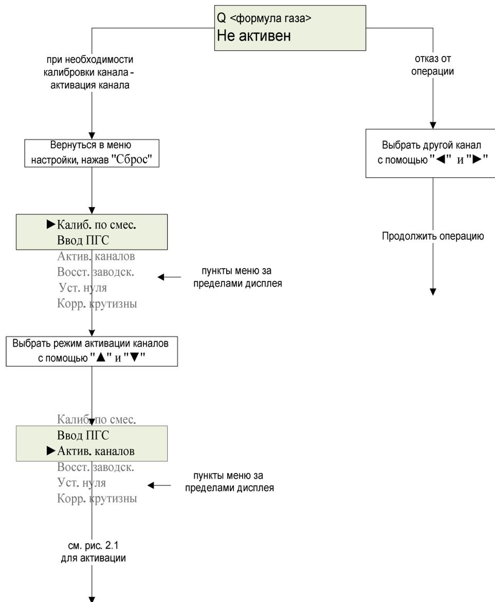
Примечание: из любого состояния можно вернуться в режим измерений, последовательно нажимая "Сброс".
