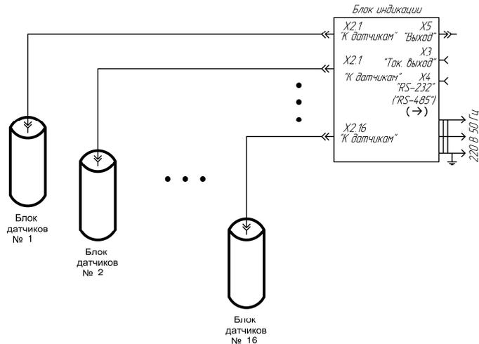
Рис Д.6 Подключение блоков датчиков исполнения И21(з) И22 (з) («звезда») по схеме "Звезда".
