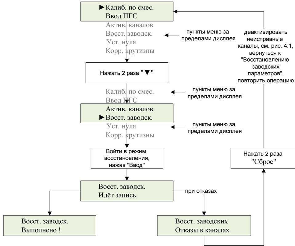
Примечание: из любого состояния можно вернуться в режим измерений, последовательно нажимая "Сброс".
