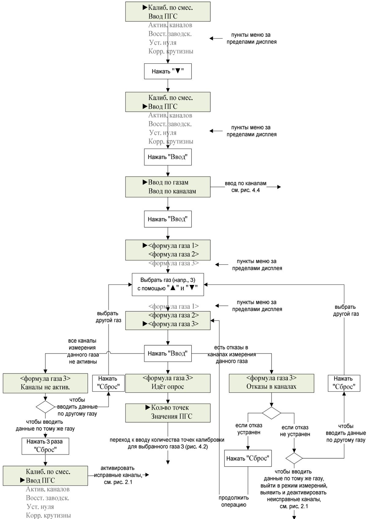
Примечание: из любого состояния можно вернуться в режим измерений, последовательно нажимая "Сброс".
