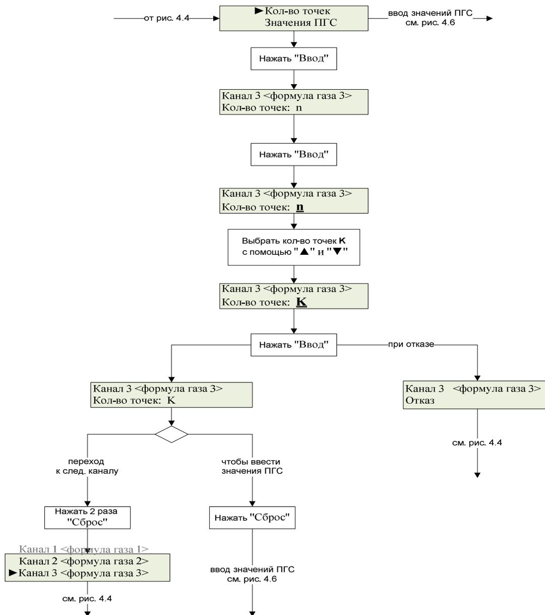
Примечание: из любого состояния можно вернуться в режим измерений, последовательно нажимая "Сброс".
