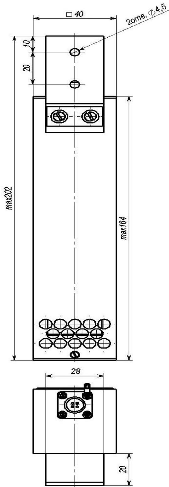
Рис.Е.5. Блок сенсоров (взрывозащищенный).
